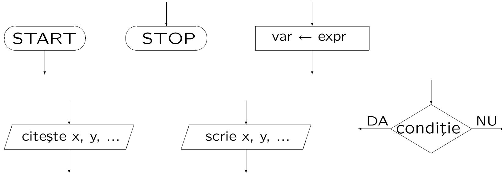
schemă logică: graf format din cele 6 tipuri de instrucțiuni, cu un singur nod de START și unul singur de STOP
